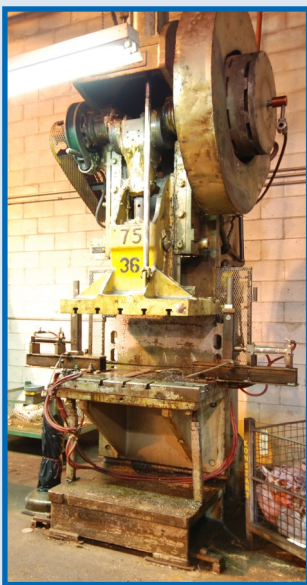
CLEARING 75 TON PRESS
