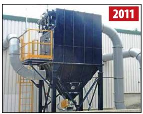
RODRIGUE 40 HP DUST COLLECTOR/FILTER, ROBOT LINE
