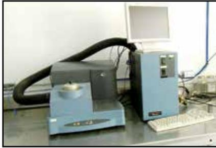
TA INSTRUMENTS DSC Q10 CALORIMETER
