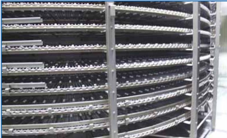
TECHNOPOOL SS 37-TIER BOLTED FRAME SPIRAL FREEZER
