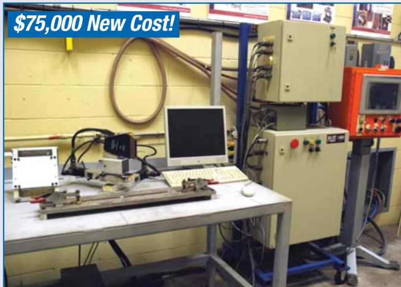
**SERVO ROBOT SEAM FINDING & TRACKING SYSTEM, MODEL PILOT**
