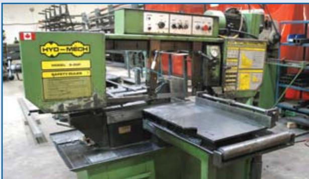
**HYD MECH SEMI AUTO HORIZONTAL BANDSAW MODEL S20P**
