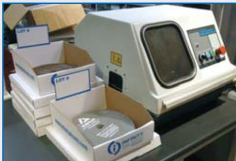
BUEHLER ABRASIVE CUTTER, MODEL ABRASIMET2
