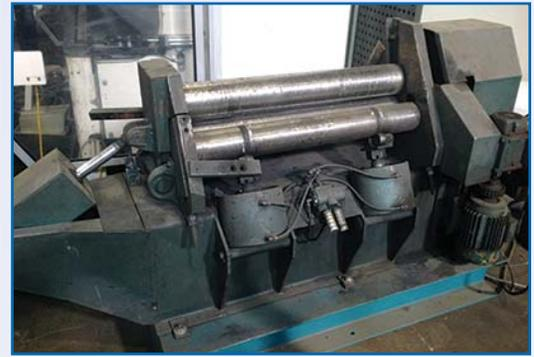
**ELAM 3' X 1/4" 4 ROLL INITIAL PINCH ROLLS, 5" DIA ROLLS**
