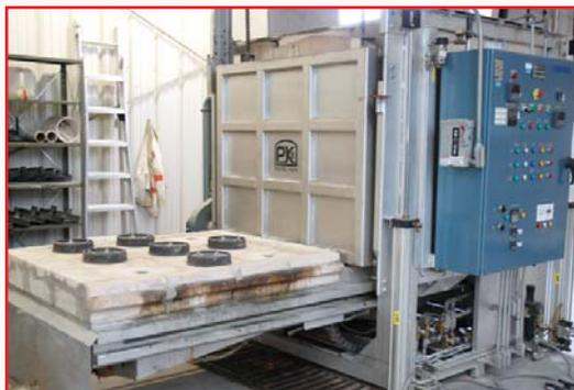
**PACIFIC KILN** FLASH FIRE DEWAX OVEN, MODEL FFDWS-9484836-DB
