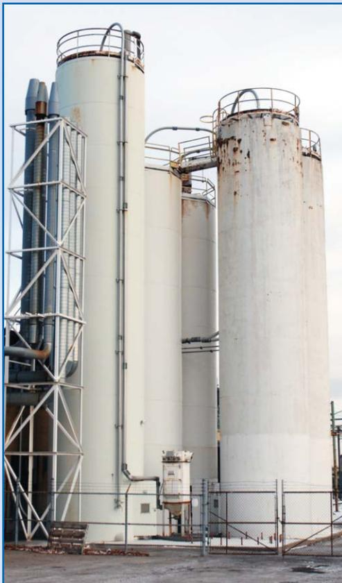
5 EPOXY LINED STEEL SILOS 12'X50'
