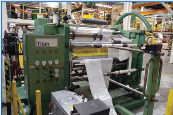
**TITAN 60" CANTILEVERED SLITTER MODEL SR5**
