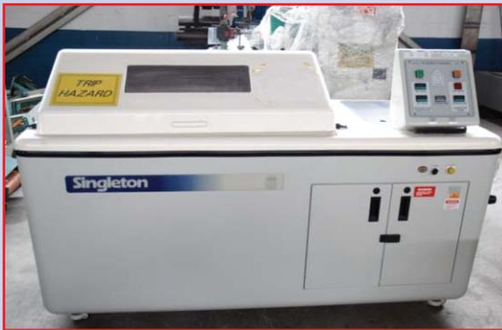
**SINGLETON** PSF22 MULTI FOG CORROSION TEST CHAMBER
