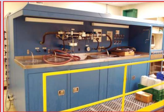
**DIAGNOSTICS** OIL FILTER MULTI PASS TEST STAND MODEL 4572
