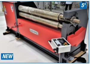
AKYAPAK ASM-S 170-157 3-ROLL INITIAL PINCH PLATE ROLLS
