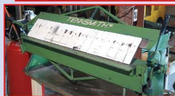
**TENNSMITH MODEL HPU 48 BOX & PAN BRAKE, 4' X 16 GAUGE CAPACITY**
