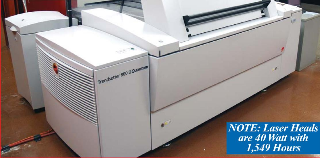
CREO TRENDSETTER 800 II QUANTUM, COMPUTER TO PLATE DEVICE
