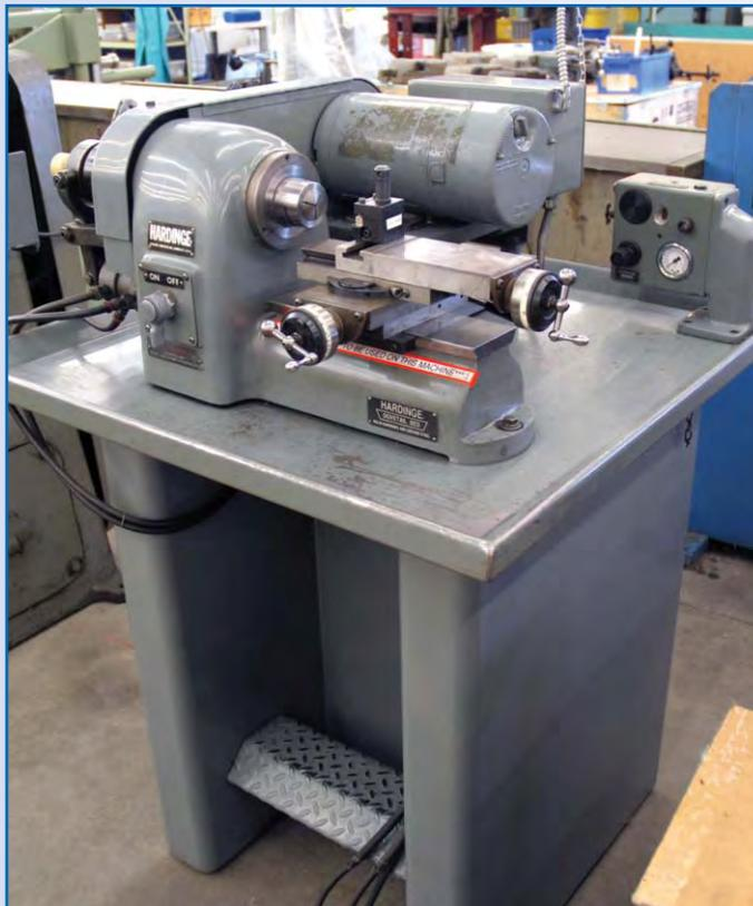
**HARDINGE DOVETAIL 2ND OPERATION LATHE, MODEL HSL59**
