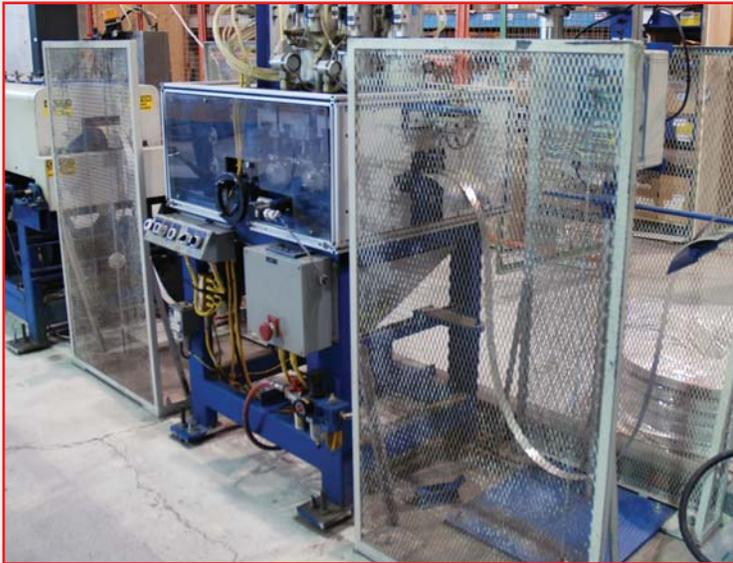
LOOP CONTROL 1 & 2, STRAIGHTENER / FEEDER / CUTTER PRESS W FEEDER PRESS DIES
