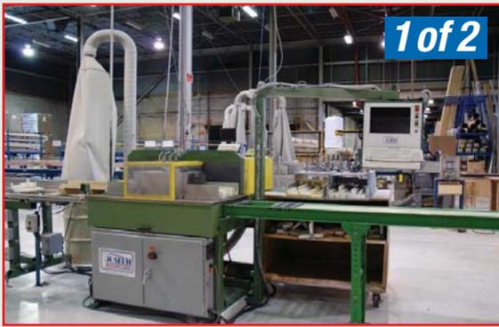
**JOSEPH MACHINE 45 & 90 DEGREE ZERO SCRAP SAW, MODEL ZDM 4590/CIF-24**
