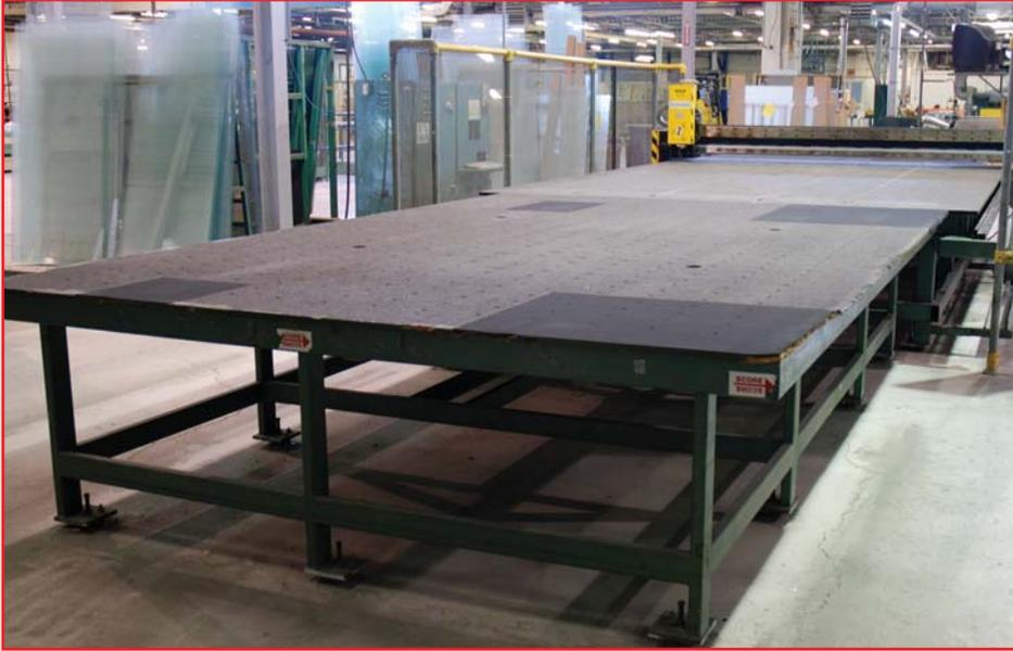
GED MODEL 6000 CNC OPTIMIZED CUTTING TABLE
