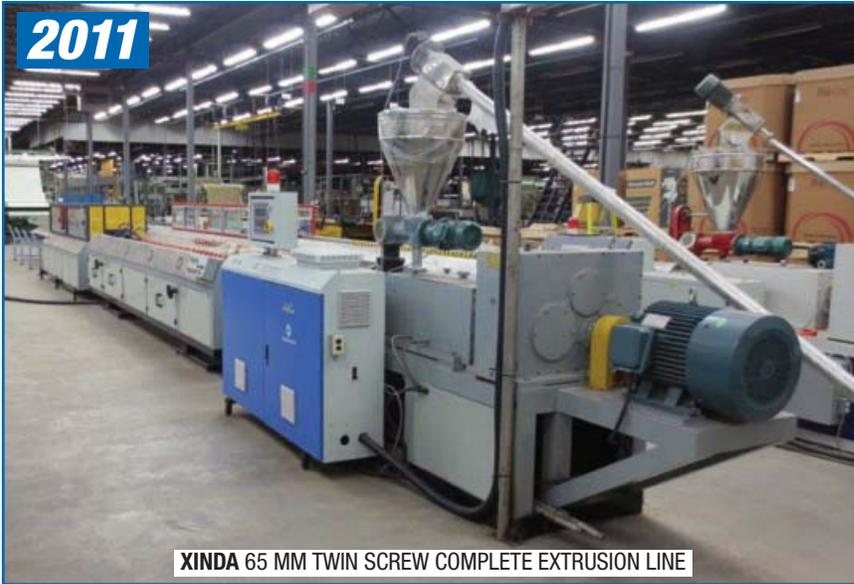
XINDA 65 MM TWIN SCREW COMPLETE EXTRUSION LINE
